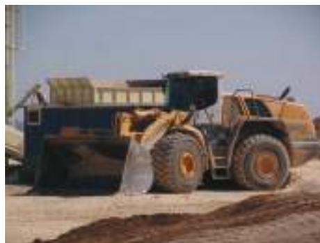
En cualquier caso la pala cargadora es una máquina empleada fundamentalmente en operaciones de carga o acopio de materiales, tanto en las zonas de explotación como en plantas de tratamiento, no estando destinada por lo general al arranque.
