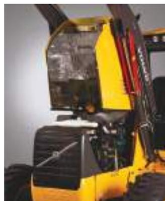
Complementariamente al sistema de bloqueo que proporcionan los bulones, se puede recurrir cuando así disponga de ello la máquina, a otros elementos del tipo barras de seguridad, empleadas para actuar de soporte del sistema brazo-cuchara cuando así sea necesario, a modo de puntales de apoyo.
