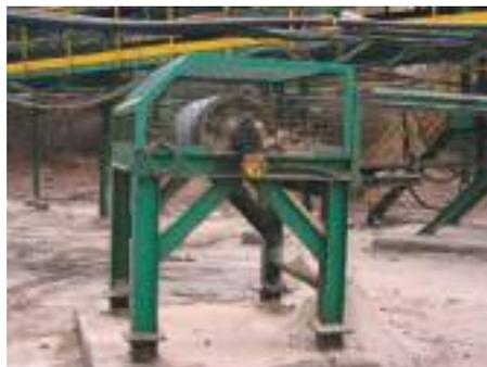
⚙️ *Estructura intermedia*: estructura metálica modular, compuesta por largueros o bastidores, con estaciones para los *rodillos superiores*, y estaciones de *rodillos inferiores o de retorno*. En el caso de cintas que deban tener una vida útil prolongada se las suele apoyar en pedestales ubicados sobre zapatas de hormigón realizadas a tal efecto, espaciados a una distancia regular a lo largo de todo su recorrido.
