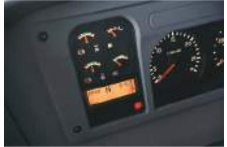
En los modelos con dispositivos de lectura electrónica ese tipo de avisos puede realizarse de diversas formas que incluyan tanto el aviso acústico como la emisión de un código de error en una pantalla.
