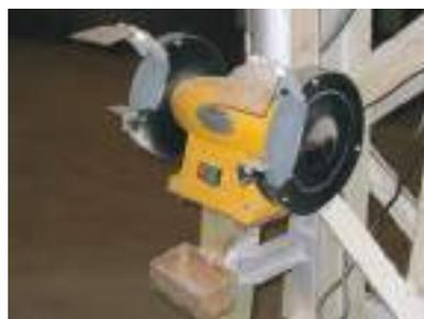
Todos los golpes, choques, contactos bruscos con la muela, etc. pueden originar fisuras o deterioros que disminuyen la resistencia de la misma.
