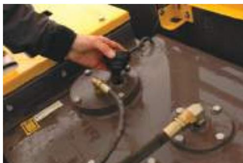
El filtro de líquido hidráulico ha de comprobarse cuando el aceite esté ligeramente caliente y el motor funcione a todo gas.
