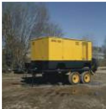
Esencialmente consisten en equipos que captan el aire atmosférico para comprimirlo y así aumentar su presión, necesaria para ser utilizada en forma de energía neumática (aire comprimido) para el accionamiento de máquinas, equipos y herramientas.
