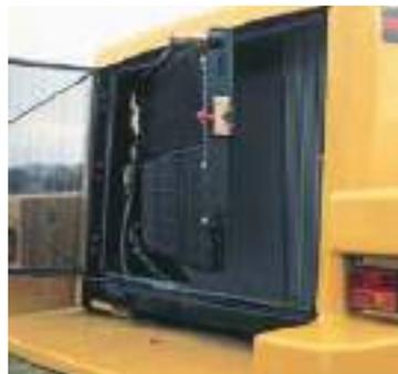
Los sistemas de refrigeración están basados en el empleo de radiadores (de agua o de aceite, según el tipo de máquina) enfriados por aire generado por un ventilador alojado por detrás de aquellos.
