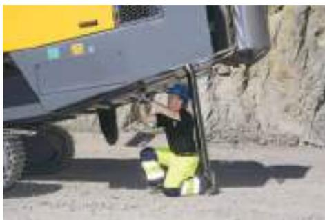
El gato no es un elemento autorizado para trabajar debajo de un vehículo. Es necesario utilizar algún tipo de dispositivo de fijación permanente que ofrezca la seguridad necesaria.
