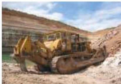
La cabina ha de estar dotada de las ya mencionadas estructuras de protección frente a vuelco (ROPS) y ante caídas de objetos (FOPS).
