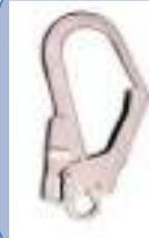
**Conectores:** Los conectores son el sistema de unión de los diferentes elementos de un sistema de seguridad anticaídas y su resistencia no deberá ser menor a 18 KN. Son anillos de metal con una apertura de cierre automático materializado mediante una pestaña
